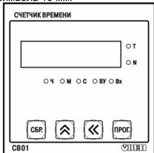
Рисунок 3.4 – Внешний вид лицевой панели прибора для корпуса настенного (Н) и щитового (Щ1) крепления
