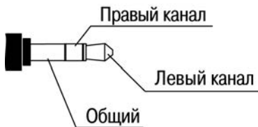
Рисунок 3.5 – Назначение контактов штекера для аудио-выхода
