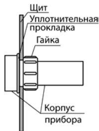
Рисунок 5.1 – Монтаж прибора в щит
