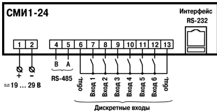
Рисунок Б.2 – Схема подключения питания, дискретных входов, интерфейсов RS-232 и RS-485 панели СМІ1-24
