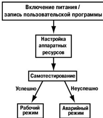
Рисунок 3.1 – Алгоритм запуска прибора
