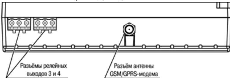
Рисунок 3.2 – Вид на верхнюю поверхность ПЛК323.ТЛ
