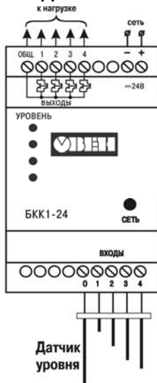
Рисунок Б.1 – Схема подключения БКК1-24
