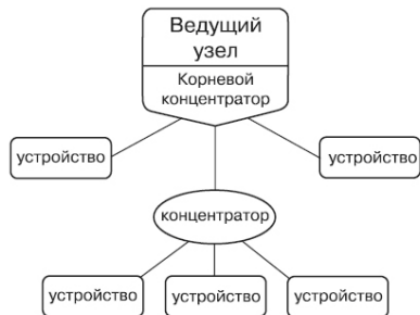
Рисунок 1.2 – Топология физической шины USB
