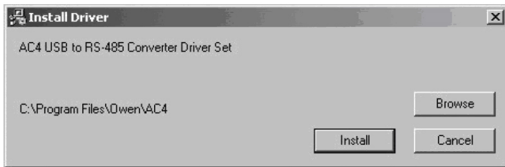
Рисунок 7.1 – Экранная форма выбора папки для установки драйвера
