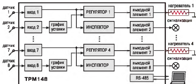
Модификация 5. 4 канала регулирования по ПИД- или ON/OFF-закону. Параллельно – контроль нахождения регулируемой величины в заданном диапазоне. Кроме того, проводится коррекция уставки по графику зависимости от измеряемой на соседнем входе физической величины.
