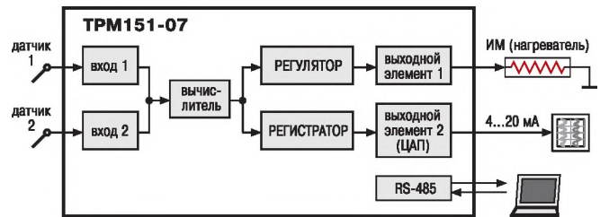
Одноканальное пошаговое регулирование по измеренной или вычисленной величине. Эта величина дублируется на ЦАП 4...20 мА, к которому подключается аналоговый регистратор. Применяется при автоматизации процессов, требующих регистрации на аналоговых самописцах
