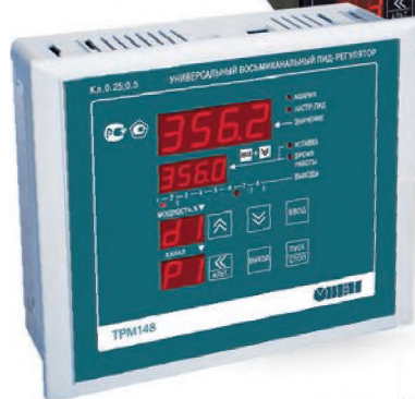
Щ4 Щитовой, 96×96×145 мм, IP54 со стороны лицевой панели
